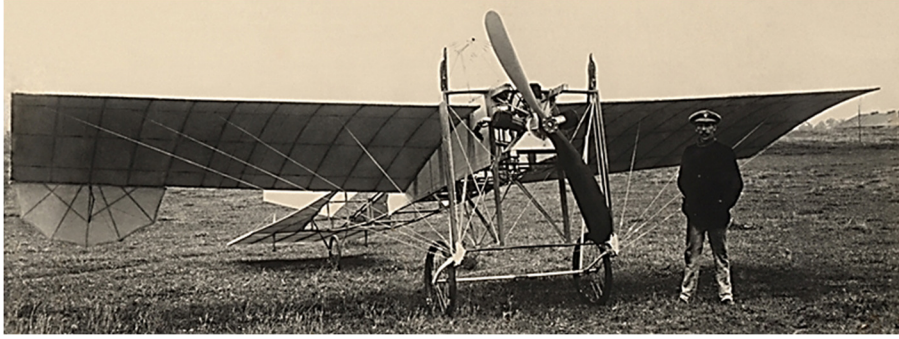
Avion "Sarić" iz 1910. sa klipnim trocilindričnim motorom "Anzani" 18,5 kW
