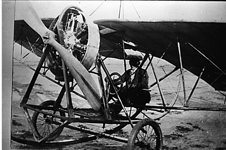
Avion "Sarić II-B" sa Delfos"-ovim sedmocilindričnim rotativnim motorom, fabričkom elisom i usmerivačem strujanja.
